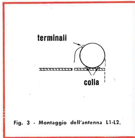
Fig. 3 - Montaggio dell'antenna L1-L2.
