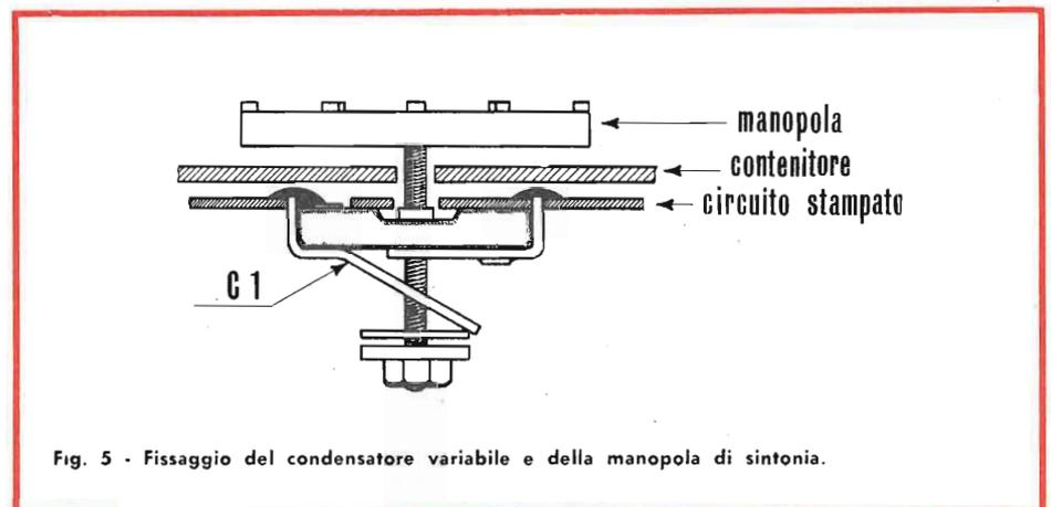
Fig. 5 - Fissaggio del condensatore variabile e della manopola di sintonia.
