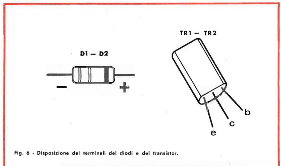
Fig. 6 - Disposizione dei terminali dei diodi e dei transistor.
